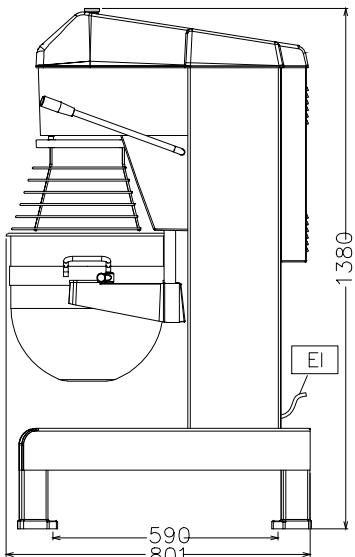
**EI** = Conexión eléctrica (energía)
